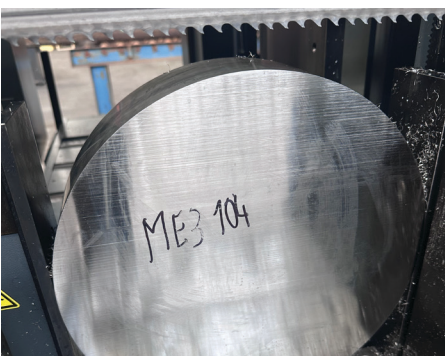
Superlega Rene-104 diametro 300 mm
